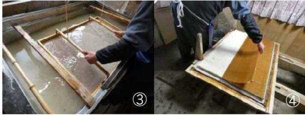
③すげたを使い原料をすくい上げ左右にゆり動かして紙にし、④漉き上げた順に1枚1枚重ねていきます。
