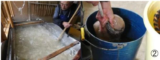
①漉き舟に水と原料をいれ十分にかき混ぜ、②次にトロアオイの粘液を漉して投入し馴染ませると、繊維同士が分離し均一に分散する。
